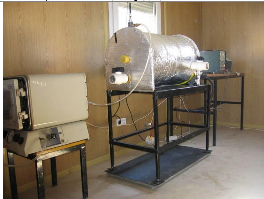
Biokonténer, HSAD reaktor
