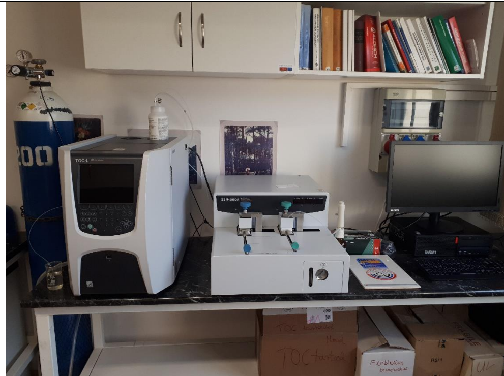
Shimadzu TOC flotálóberendezés folyékony és szilárd mérőegységgel
